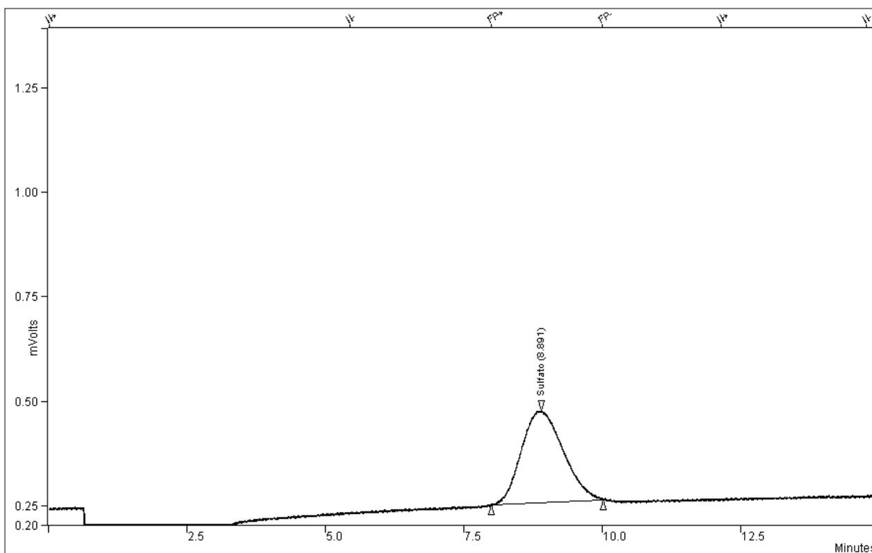
**Equipamento:** HPLC-IC Waters**Coluna:** IC-Pak A 4.6 x 50 mm**Eluente:** Borato de Sódio / Gluconato**Fluxo:** 1 ml/min.**Temperatura Coluna:** Não Aplicável**Volume Injetado:** 200 µL**Concentração:** 20 mg/L**Diluição:** 50x
