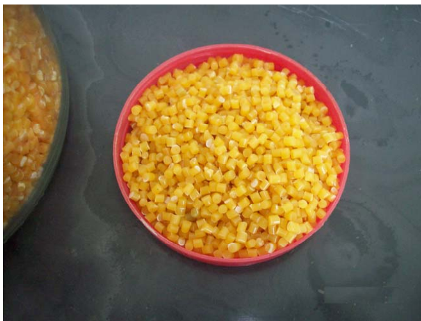
Peletes de Thermpan de 3mm x 3mm de diâmetro
