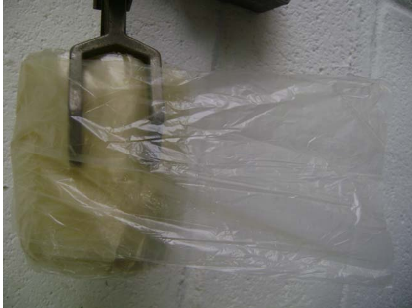
Filme transparente de Therman com 10 \mu\text{m} de espessura x 100 mm largura
