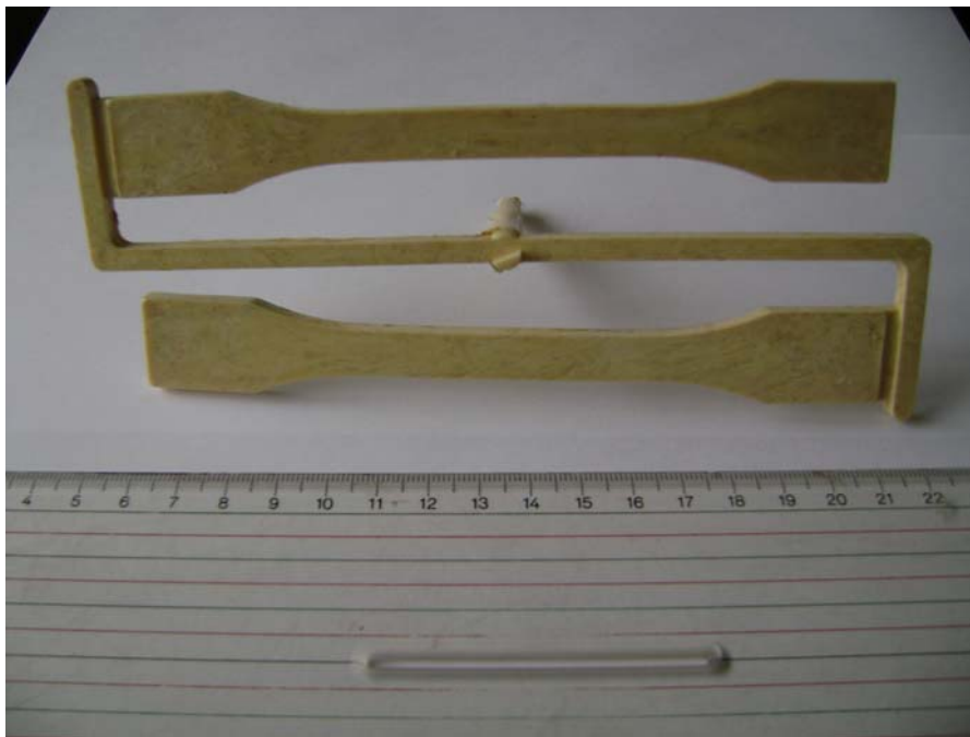
Peça Injetada de Therman de 30g
