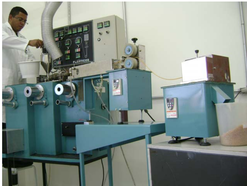
Extrusora de Thermpan desenvolvida pela Quimlab
