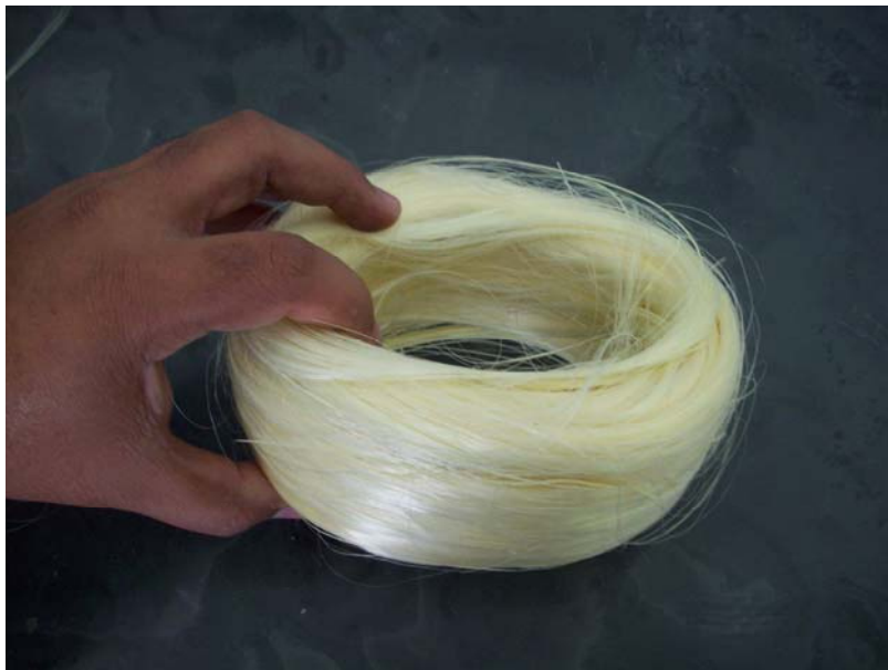
Cabo de fibras de Thermpam com 144 filamento de 50 \mu\text{m}
